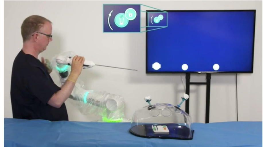
Fulcro Virtuale: assenza di aggancio meccanico tra braccio e trocar
