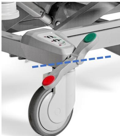
**3.1** - Sblocco della leva del freno in posizione Orizzontale.
